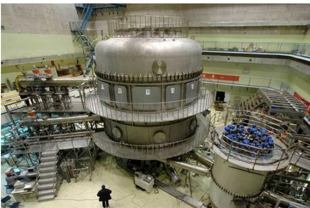
图 1: 全超导托卡马克 EAST (原名 HT-7U) 核聚变实验装置
